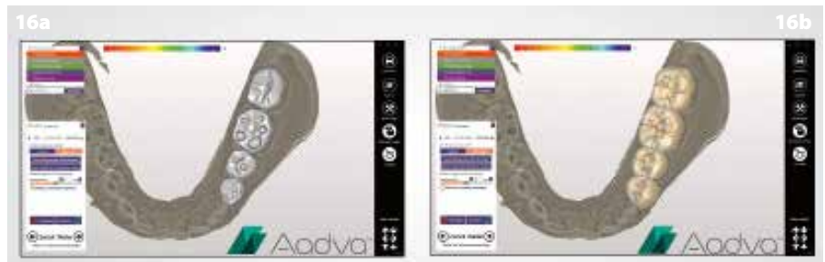
Abb. 16a & b: Die Onlays werden nach Digitalisierung der Ausgangssituation mithilfe von Konstruktionssoftware virtuell modelliert.
