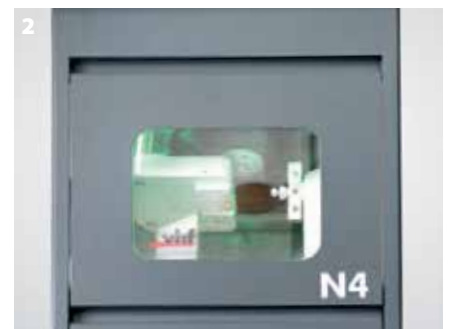
Abb. 1 bis 3: Arbeitsschritte bis zur fertigen Cerasmart Restauration: Scannen (hier Aadvia Laborscanner), Konstruktion, Nassschleifen (hier mit der N4-Fräsmaschine).
