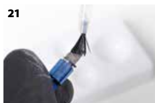
Fig. 21: La superficie de cementado se cubre uniformemente con primer.
