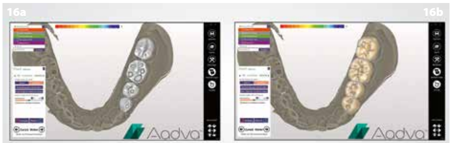
Figs. 16a & b: Las incrustaciones se modelan virtualmente tras la digitalización de la situación utilizando software de construcción.
