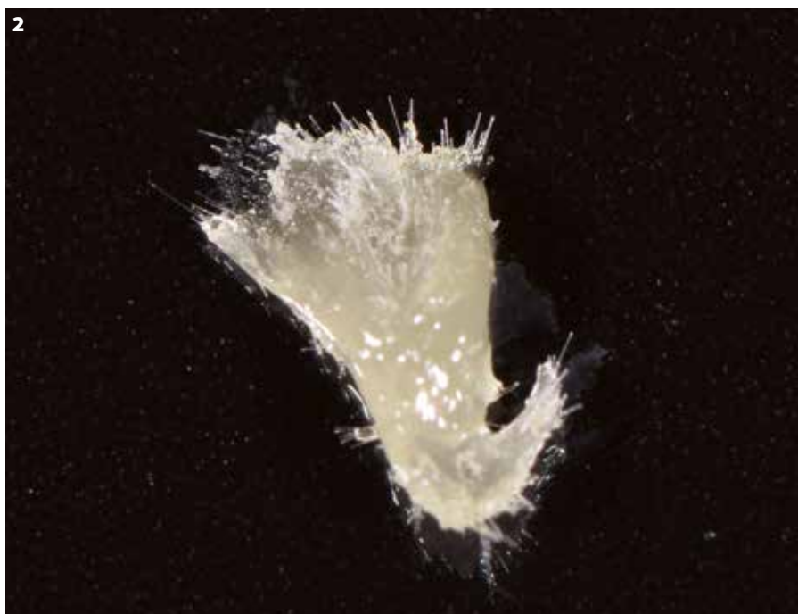
Figura 2: El tamaño único de las fibras cortas puede verse al extruir un poco del material SFRC, del unitip
