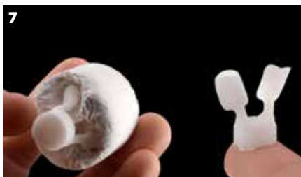
Fig. 7: El prensado da un resultado homogéneo, sin que se forme prácticamente ninguna capa de reacción.
