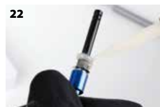
Fig. 22: Le matériau de fixation est uniquement appliqué sur le tiers supérieur de la base de collage.
