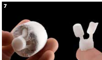
Fig. 7: La pressée produit un résultat homogène, pratiquement sans formation d'une couche de réaction.
