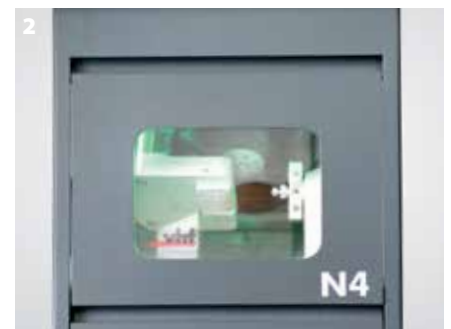
Figg. 1-3: Passaggi di lavoro fino al restauro finito con Cerasmart: scansione (qui scanner da laboratorio Aadvia), costruzione, sgrossatura a umido (qui nel fresatore N4).
