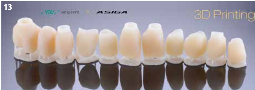
Abb. 13: Zweiter Satz provisorischer Restaurationen, gedruckt mit GC Temp PRINT (Farbe Medium) und dem Asiga Max UV 3D-Drucker
