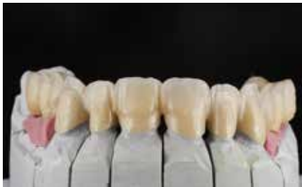
Abb. 20: Das aus der Zr Disk gefräste Gerüst, mit Infiltrationsfarben gefärbt und gesintert.
