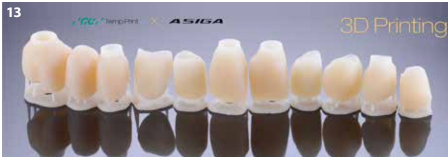
Fig. 13: Secondo set di restauri provvisori stampati con GC Temp PRINT (colore medio) usando la stampante 3D Asiga Max UV.
