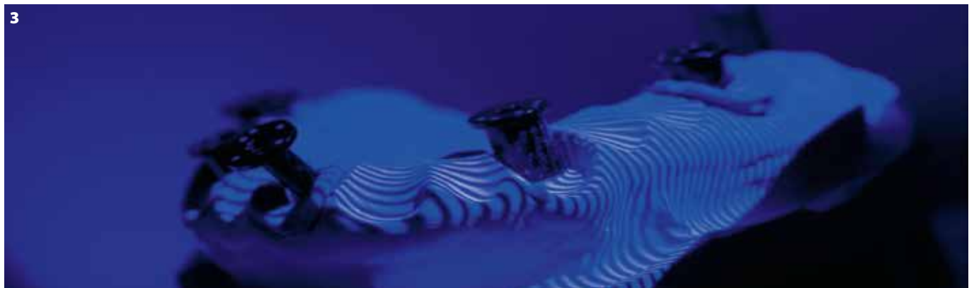
Figura 3: Todas las partes del modelo relevantes para nuestro trabajo se escanean mediante luz LED azul estructurada.
