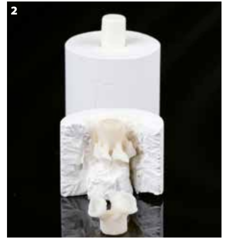
Figura 2: LiSi Press después de la inyección: la capa de reacción inexistente o muy fina simplifica el desvestido y arenado.
