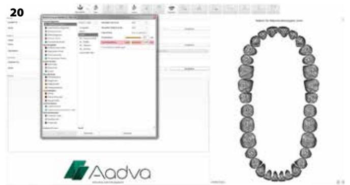
**Figura 20:** Scegliendo un'intercapedine negativa per il cemento si è potuto evitare l'uso dello spray per la scansione. Questo rispecchiava la costruzione primaria.
