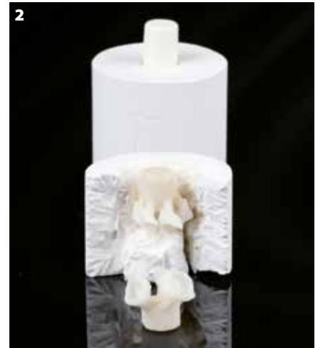
**Figura 2:** LiSi Press dopo la pressatura: lo strato di reazione è sottilissimo o inesistente e questo semplifica la rimozione dallo stampo e la sabbatura.
