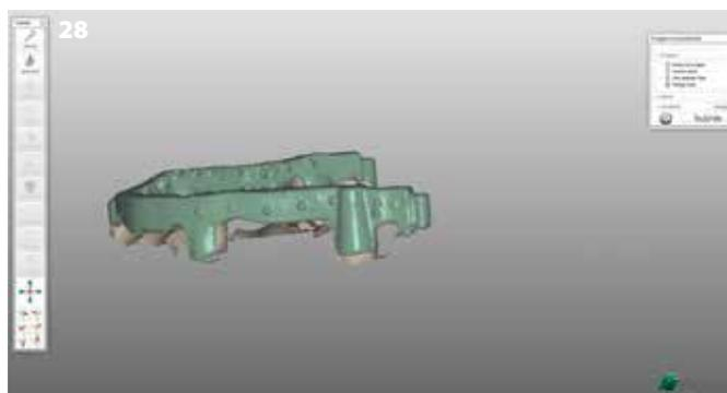
**Figura 28:** Abbiamo inviato i dati finali del bracket della barra al nostro fresatore a 5 assi da laboratorio.
