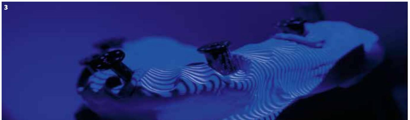
**Figura 3:** Tutte le parti del modello rilevanti per il nostro lavoro vengono scansionate usando luce a LED blu strutturata.
