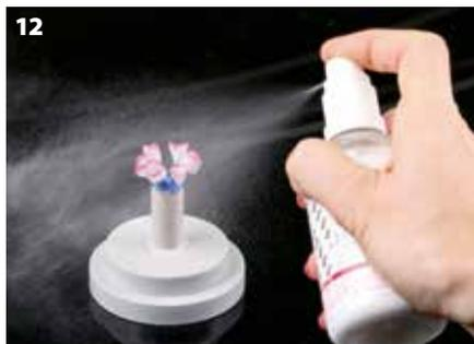
**Figura 12:** Sulle superfici di cera viene spruzzato il liquido SR per rifinire le superfici usando l'esempio delle corone degli elementi frontali
