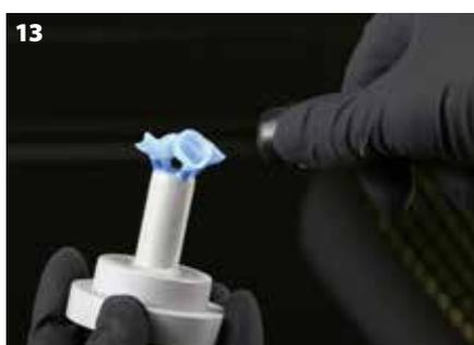
**Figura 13:** Dispersione totale del liquido con aria pressurizzata usando l'esempio delle corone degli elementi posteriori
