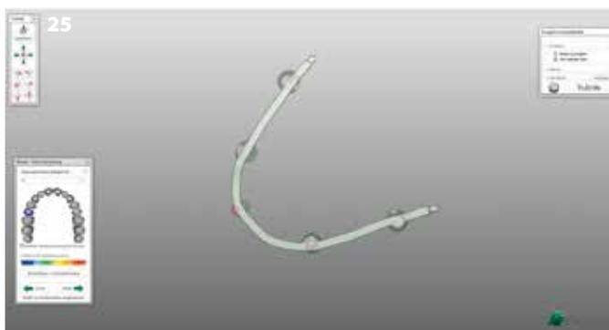
**Figura 25:** Sull'immagine dall'alto si possono vedere le superfici laterali parallele della barra – questo garantisce di poter inserire perfettamente la parte della barra secondaria.
