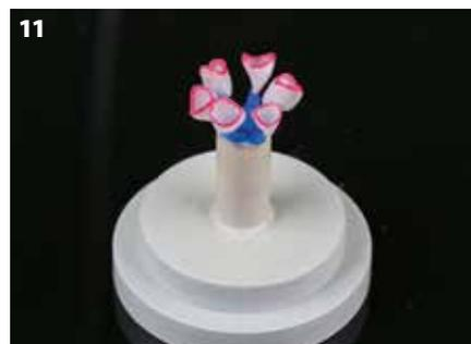
**Figura 11:** I modelli in cera sono stati impernati sulla base del cilindro con le corone dei denti frontali come esempio.
