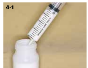
Figura 4-1: puede efectuar la medición de manera rápida y precisa con una jeringa, en lugar de un cilindro graduado.
