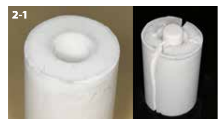
Figura 2-1: izquierda: grietas tras la abrasión. Cuando se coloca el cilindro en el horno de cilindros a 500 °C y, a continuación, se eleva la temperatura a 900 °C, pueden aparecer grietas en el cilindro, como se muestra en la figura. Derecha: como se muestra en la figura, el revestimiento con resistencia a la compresión reducida puede fallar durante la inyección.
