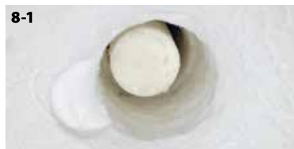
Figure 8-1 : Comme illustré dans la figure, la céramique pressée s'accumule de plus en plus sur la surface du piston de pressée si elle n'est pas éliminée. La céramique pressée déposée sur ce composant doit donc être périodiquement grattée.
