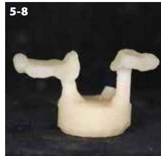
Figure 5-8 : Lorsque les tiges de coulée ont été fixées comme le montre cette figure, la pression ne peut être appliquée entièrement sur la partie la plus profonde de l'objet, ce qui donne lieu à un objet défaillant.
