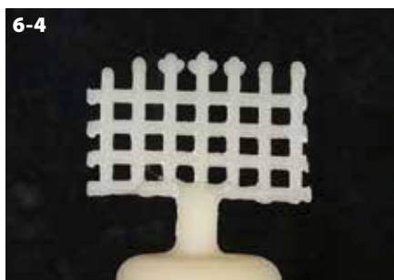
Figure 6-4 : Condition de pressée idéale du modèle de grille (la maquette en cire de la grille de rétention GEO à mailles fines de Renfert, et la tige de coulée R25 sont utilisées).
