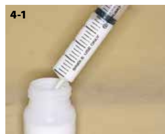
Figure 4-1 : La mesure peut être effectuée rapidement et précisément au moyen d'une seringue plutôt qu'un cylindre gradué.
