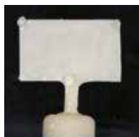
Figure 3-1 : La longueur de chaque tige de coulée présentée dans les images gauche et droite est de 3 mm et 5 mm, respectivement. La cire à modeler prête à l'emploi R25 a été utilisée pour les deux tiges de coulée et des cires en feuille de 0,46 mm d'épaisseur pour le moulage à la presse.
