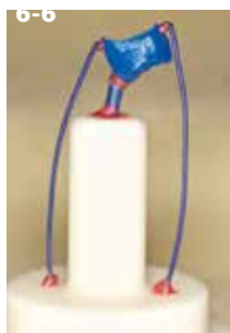
Figure 6-6: Lorsque les tiges de coulée sont placées sur le modèle selon la direction illustrée dans la figure, l'air pourrait être piégé dans la surface indiquée par la flèche et mener localement à des limites marginales tronquées.
