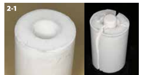
Figure 2-1 : Gauche : fissures après cuisson. Lorsque le cylindre est placé dans le four à 500°C et que la température est poussée à 900°C, le cylindre peut se fissurer comme le montre la figure. Droite : comme le montre la figure, le matériau de revêtement de moindre résistance à la compression peut se fracturer lors de la pressée.
