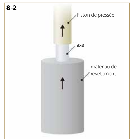
Figure 8-2 : Lorsque la pressée est terminée, le piston de pressée soulève l'axe et provoque l'aspiration de la céramique pressée.
