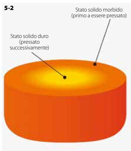
Figure 5-2: Stato di un lingotto fuso in sezione.
