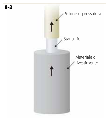
Figure 8-2: Quando la pressatura è completa, il pistone di pressatura solleva lo stantuffo per risucchiare la ceramica pressabile.
