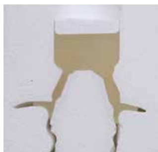
Figura 5-6: Fusione a pressione in uno stampo per rivestimento.
