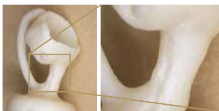
Figura 7-2: Traccia di aria fuoriuscita dal perno di colata.
