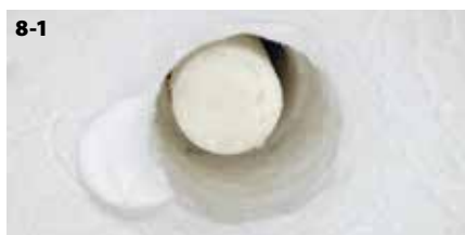
Figure 8-1: Come indicato nella figura, le ceramiche pressabili si accumulano sempre più sulla superficie del pistone di pressatura se non si eliminano le ceramiche pressabili attaccate. Dunque le ceramiche pressabili attaccate a questa parte devono essere rimosse periodicamente.
