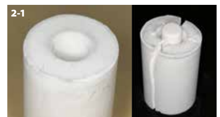
Figura 2-1: A sinistra: Fratture dopo l'eliminazione della cera. Quando il cilindro viene posto nell'apposito forno a 500°C e poi la temperatura viene aumentata a 900°C, il cilindro si può fratturare come mostra la figura. A destra: Come riportato in figura, il rivestimento, avendo una minor resistenza alla compressione, può cedere quando viene pressato.
