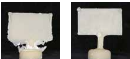
Figura 3-1: La lunghezza del perno di colata a sinistra è di 3 mm mentre quella del perno a destra è di 5 mm. Per entrambi i perni di colata si è usata la cera Ready Casting Wax R25 e lamine di cera dello spessore di 0,46 mm per lo stampaggio a pressione.
