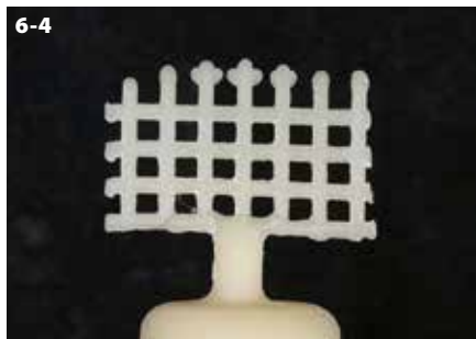
Figura 6-4: Condizione di pressatura ideale nel modello reticolare. (Si è usato il modello in cera della griglia di ritenzione GEO, sottile di Renfert e il perno di colata R25)
