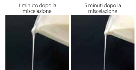
Figura 4-2: Fluidità di LiSi PressVest.
