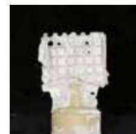
Figure 3-2: Le ceramiche pressabili si infiltrano nel rivestimento quando la temperatura di fusione è troppo alta.
