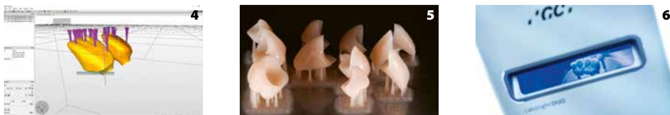
Fig. 4-5-6 : Les couronnes sont positionnées et prêtes pour l'impression, chaque matériau requiert une intensité lumineuse, une taille du support et une force de séparation différentes. Grâce à ses propriétés, Temp PRINT est étonnamment facile à imprimer et offre une finition parfaitement lisse. Après l'impression, les couronnes sont nettoyées à l'alcool isopropylique et une dernière polymérisation est effectuée dans l'unité Labolight DUO.
