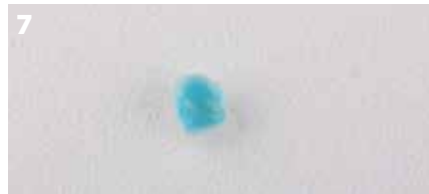
Abb. 7: Reinigen mit Phosphorsäure (37 %) zur Entfernung verbliebener Ablagerungen.
