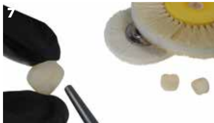
Fig. 7: Prima dell'individualizzazione e della sigillatura della superficie con OPTIGLAZE color, si deve ottenere una ruvidità di circa 50 \mu\text{m} .
