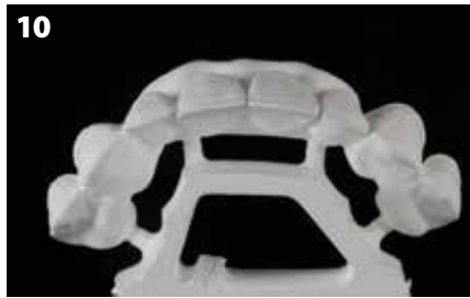
Fig.10: Zirconia allo stato a verde, prima della sinterizzazione. Grazie alla digitalizzazione ora qualunque caso è riproducibile.
