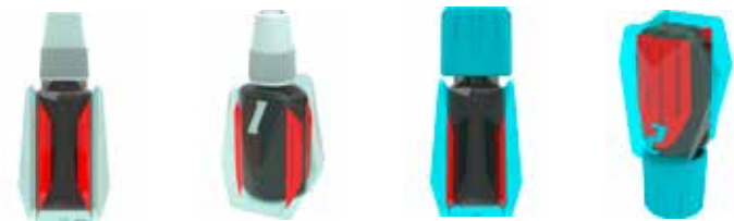
Verkleinerter Kontaktpunkt zwischen Schutzhülle und Flasche
