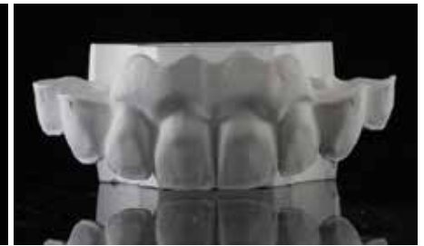
Fig.10: irconia en estado verde, antes de la sinterización. Gracias a la digitalización, cualquier caso es ahora reproducible.
