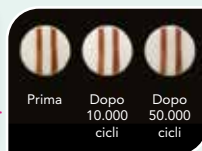
Test di usura da spazzolamento, colore red brown
