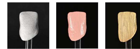
Application de l'Initial INmetalbond (étape facultative). Après cuisson, le liant doit avoir une surface jaunâtre, légèrement brillante.
