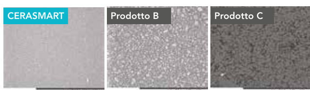
CERASMART270 è composto da matrice resinosa e riempitivi ultrafini ed omogenei. Questa particolare composizione conferisce al materiale eccezionali caratteristiche meccaniche.
