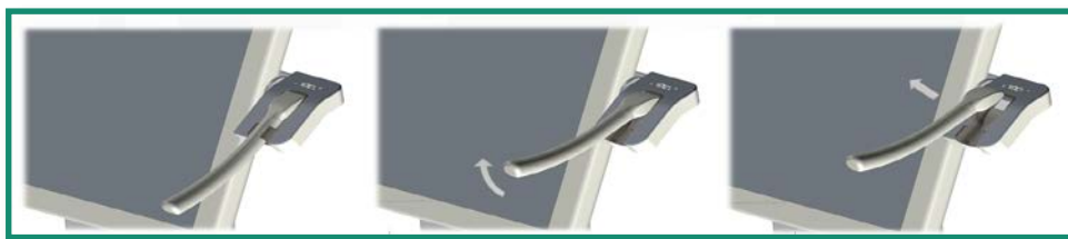
Figura 44: rimozione del manipolo
