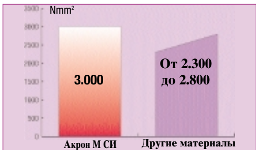
Модуль эластичности: ДЖИ СИ Акрон М СИ по сравнению с другими материалами
