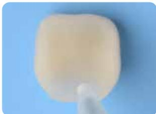
O CERASMART270 é o único material cerâmico híbrido que pode ser condicionado com ácido fluorídrico ou limpo com jato de areia.
