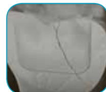
Традиційний композит: поширення тріщин через матеріал реставрації.
