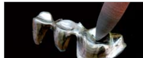
Fig. 40 Avant le sablage à l'aide d'oxyde d'alumine de 110 microns, l'intégralité de la surface de l'armature est lissée à l'aide d'un polissoir en silicone afin d'éviter les bords tranchants et également de détecter les éventuelles porosités de la coulée et d'éliminer tous les plis métalliques (en particulier lorsque des bio-alliages à forte teneur en or sont utilisés) qui pourraient se traduire par des bulles ou des fissures dans la porcelaine.
