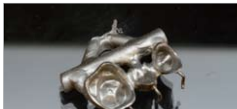
Fig. 28 Coulée démoulée utilisant un alliage palladium précieux. Remarquez l'état de surface régulier obtenu grâce à Fujivest Platinum.
