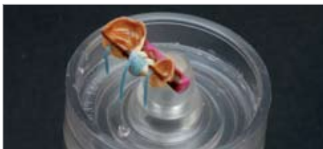
Fig. 27 Un système de coulée sans cylindre peut être utilisé avec Fujivest Platinum pour l'expansion libre et uniforme du revêtement et pour maintenir la contamination par l'oxyde métallique du four à un minimum si celui-ci est également utilisé pour l'enfournement des cylindres pour les céramiques pressées.
