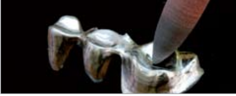
Fig. 40 Înaintea sablării, prin utilizarea oxidului de aluminiu la 110 microni, întreaga structură de metal este netezită, folosind un silicon pentru a evita colturile ascuțite și de asemenea pentru a detecta porozitățile apărute la turnare și pentru a elimina eventuale gaze ce pot apărea în metal (mai ales atunci când se folosește bio aliaj moale, ce conține mult aur), ce pot determina apariția bulelor sau a fisurilor în porțelan.
