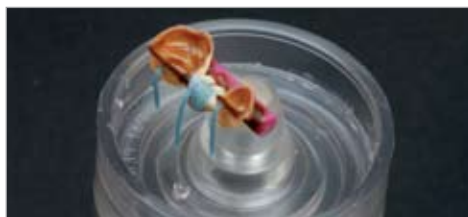
Fig. 27 Cu GC Fujivest Platinum se poate folosi un sistem de turnare fără inel pentru expansiunea uniformă a masei de ambalat și pentru a nu contamina cuptorul cu oxid de metal, în cazul în care se folosesc inele de ceramică presată.
