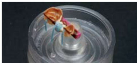
27. ábra Gyűrű nélküli öntőrendszer alkalmazása Fujivest Platinum beágyazóval az egyenletes és akadálytalan expanzió érdekében, valamint a kályha fémoxidokkal történő szennyeződésének minimalizálására, amennyiben azt préskerámiákhoz való gyűrűk kiegészítésére is használják.
