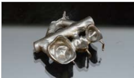
28. ábra A kibontott, normál Pd-tartalmú nemesfémötvözetből készült öntvény. Figyeljük meg a finom felszínt, melyet a GC Fujivest Platinum nyújt.
