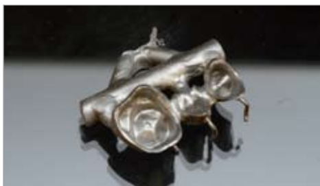
Ryc. 28 Uwolniony odlew ze standardowego stopu palladu zawierający stop szlachetny do napalania ceramiki. Na uwagę zasługuje doskonała powierzchnia uzyskana dzięki zastosowaniu GC Fujivest Platinum.
