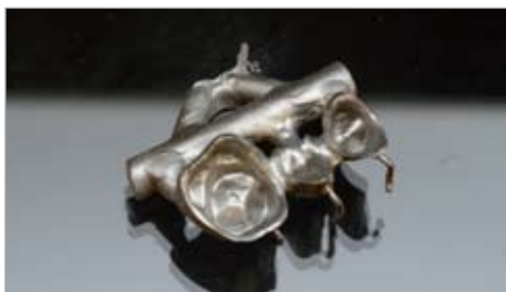
Fig. 28 Izkivetiran odlitek iz polplemenite kovine (paladija). Opažena je fina površina odlitka, ki jo pusti GC Fujivest Platinum.
