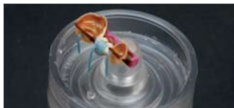
Εικ. 27 Μπορεί να χρησιμοποιηθεί σύστημα χύτευσης χωρίς δακτύλιο με το πυρόχρωμα GC Fujivest Platinum για επαρκή και ανεμπόδιστη διαστολή του πυροχρώματος και για διατήρηση της επιμόλυνσης του φούρνου με μεταλλικά οξειδία στο ελάχιστο, αν ο ίδιος φούρνος χρησιμοποιείται και για χυτά κεραμικά.
