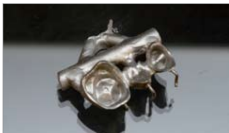
Εικ. 28 Το χυτό που προκύπτει με χύτευση βασικού παλλαδιούχου ευγενούς κράματος. Προσέξτε τη λεία επιφάνεια που καταλείπει το GC Fujivest Platinum.
