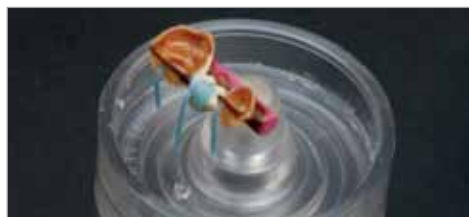
Fig. 27 È possibile usare un sistema di fusione senza cilindro con Fujivest Platinum in modo che l'espansione del rivestimento sia uniforme e non incontri ostacoli e la contaminazione con ossido del forno di cottura sia minima se il forno è usato anche per cilindri per ceramiche pressofuse.
