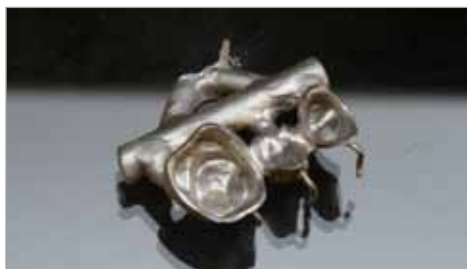
Fig. 28 Fusione (dopo l'estrazione) in palladio standard con leghe preziose. Notare la superficie liscia ottenuta con Fujivest Platinum.
