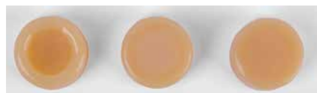
Situation initiale : cavité réalisée dans un bloc de composite en teinte A3
