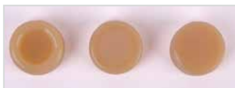
Cavité réalisée dans un bloc de composite en teinte A3 Composite faible diffusion Composite haute diffusion
