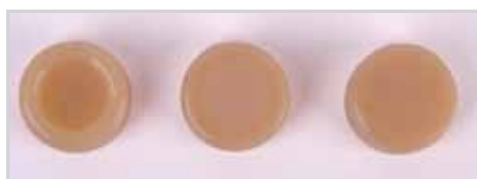
Blocco di composito di colore A3 con cavità Composito a bassa dispersione Composito ad alta dispersione
