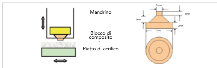
Figura 30: Allestimento del test della resistenza all'usura su tre masse
