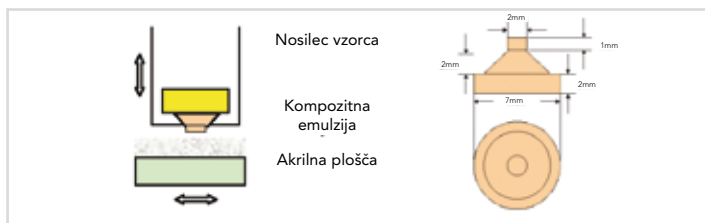
Slika 30: Nastavitev testa odpornosti proti trem vrstam obrabe
