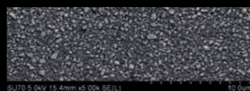
Уникална технология на пълнителя: 200 nm частици от Стронциево стъкло, хомогенно разпръснати в матрикса. SEM снимка (x2000)*
