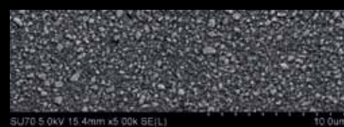
Единствена технологија на полнежи: 200 nm стаклени честички на Стронциум хомогено дисперзирани во матрицот. SEM слика (x2000)*
