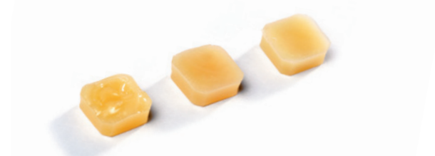
Glansscore van ongepolijste composiet. Het linkervoorbeeld is G-ænial Universal Flo
