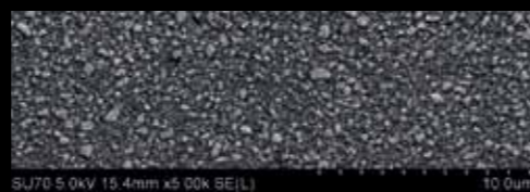
Unikalna technologia wypełniacza: 200 nm cząstki szkła strontowego równomiernie rozproszone w matrycy Obraz SEM (2000 x)*
