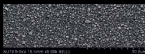
Edinstvena tehnologija polnil: 200 nm veliki delci stroncijevega stekla homogeno razpršeni v matriksu*
