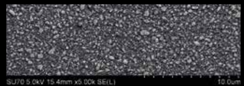
Unik fillerteknik: 200 nm strontiumglaspartiklar homogent fördelade i matrix SEM-bild (x 2000)*
