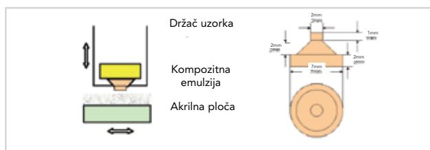
Uzorci kompozita pripremljeni su korištenjem metalnog kalupa i polimerizovani u skladu sa proizvođačevim uputstvima za upotrebu. Svi uzorci čuvani su u vodi pri 37°C u trajanju od 24 sata te su ispitivani otpornosti na trošenje izvršena pomoću stroja s tri materijala.
