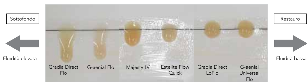
Figura 14 Viscosità di G-ænial Universal Flo - GC Corporation, Reparto Ricerca e sviluppo, Giappone
