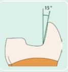
Ángulo de divergencia de las paredes axiales: 15 grados
