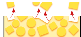
Irruvidimento della superficie e perdita di lucentezza nel tempo
