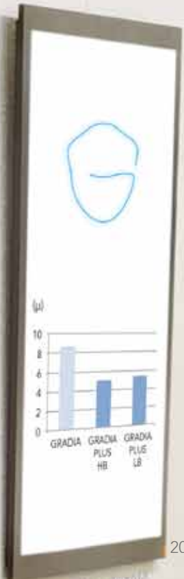
Abraziuni ocuziōnate pe smalț bovin (μ) După 200.000 de cicluri
