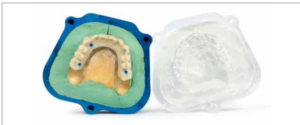
Asetage mudel tagasi küvetti, sulgege kruviaugud tefloni ja vahaga ning kruvige ülemine osa küvetile ettevaatlikult tagasi. Kontrollige, et asetused oleksid ideaalsed.
