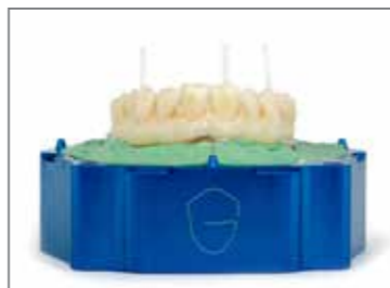
Csavarozzuk ki a küvetta tetejét, és vágjuk le a csapokat egy gyémant koronggal.
