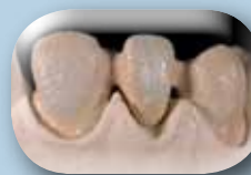
Con un pennello piatto, applicare un sottile strato di Opaco (wash) utilizzando i normali opachi GC Initial MC Paste Opaque. Prima della cottura, applicare la polvere di Fluo Crystals sulla superficie di opaco.
