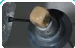
Placez Initial LiSi Block dans le dispositif de fraisage.
