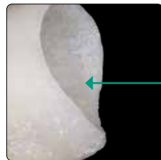
Reaktionsschicht: Hybridschicht bestehend aus Einbettmasse und Pressmaterial
